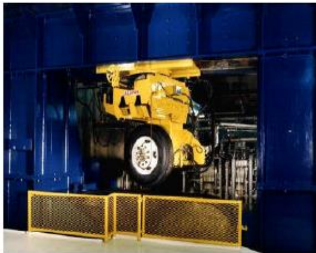
Figure 19: tyre testing machine (Kasprazk & Genz, 2006)
